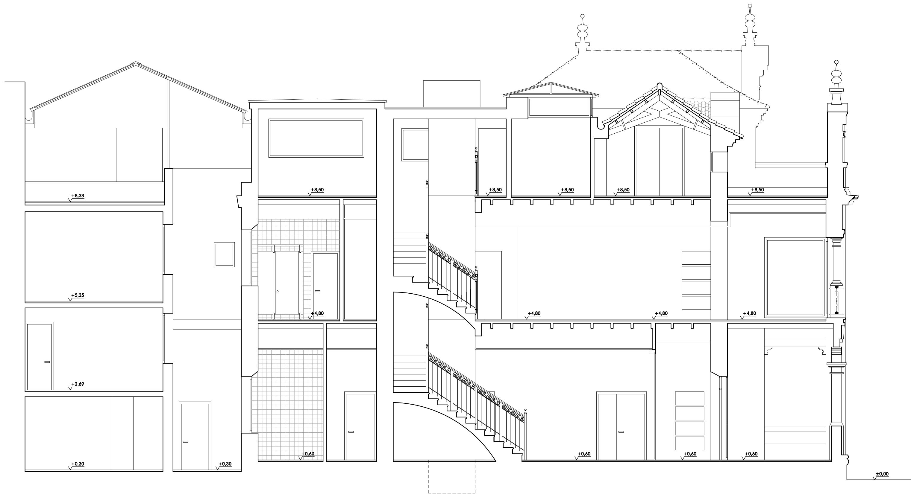
SECCION LONGITUDINAL POR ESCALERA Cotas en metros.
